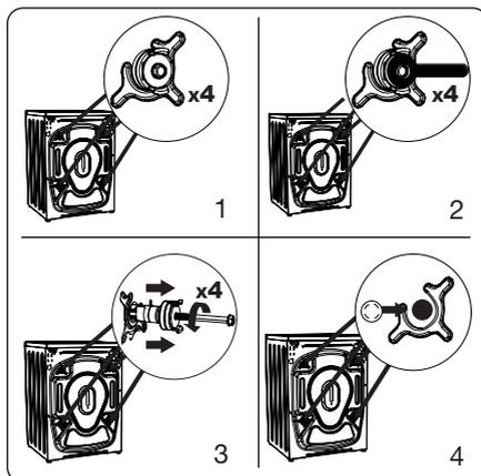
**1)** Prima di utilizzare l'apparecchio, è necessario rimuovere i quattro bulloni di trasporto e i distanziatori in gomma dalla parte posteriore dell'apparecchio. Se i bulloni non vengono rimossi, possono causare forti vibrazioni, rumori e malfunzionamenti della macchina e invalidare la garanzia.
