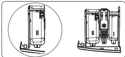
Questo scomparto è per detersivi liquidi o in polvere o detersivi anticalcare. La piastrina del livello del detersivo liquido è fornita all'interno dell'apparecchio. (\*)
