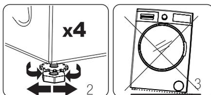
**2)** Per aumentare l'altezza della macchina, ruotare i piedini in senso orario. Per diminuire l'altezza della macchina, ruotare i piedini in senso antiorario.
