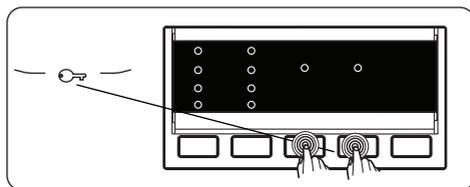
La funzione Blocco bambini impedisce il funzionamento involontario della macchina o da parte di bambini non sorvegliati.
