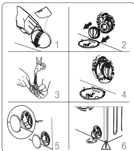
Il sistema di filtraggio della pompa nella lavatrice prolunga la vita della pompa impedendo alla lanuggine (accumulo di pelucchi) di entrare nella macchina. Si consiglia di pulire il filtro della pompa ogni 2 mesi.
