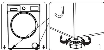
**1)** Non installare l'apparecchio su tappeti, moquette o altre superfici che possano bloccare la ventilazione alla base. La distanza tra l'apparecchio e il pavimento non deve essere ridotta con oggetti come tappeti, legno o nastri.
