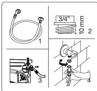
**1)** A seconda delle specifiche della macchina, quest'ultima può disporre di una singola connessione di ingresso dell'acqua (fredda) o di una doppia connessione (calda e fredda). Il tubo con tappo bianco deve essere collegato all'ingresso dell'acqua fredda e il tubo con tappo rosso all'ingresso dell'acqua calda (se applicabile).
