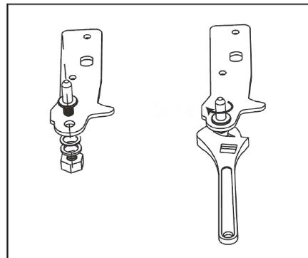
7. Riposizionare e riavvitare la cerniera inferiore, poi rimettere entrambi i piedini regolabili.
