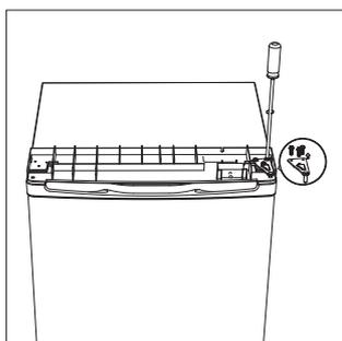
4-Rimuovere la cerniera inferiore dello sportello del vano freezer, svitando le viti che la bloccano al telaio e sfilare lo sportello, riponendolo su una superficie morbida in modo da evitare che si graffi.
