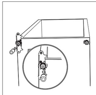
11-Reinserire la porta esterna sul perno inferiore, quindi inserire la staffa col perno superiore per fermare la porta sul lato sinistro; avvitarle in modo non definitivo le 2 viti che fermano la staffa.
