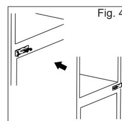
7 - Invertire la posizione del perno di arresto sulla staffa della cerniera superiore, come mostrato in figura sottostante.
