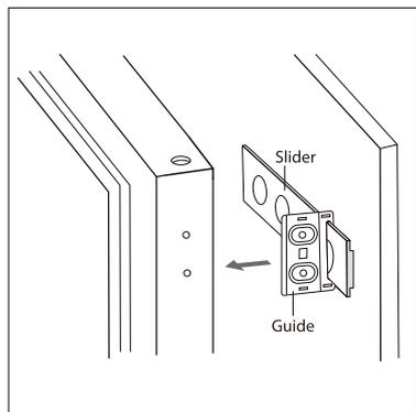
4) Ora rimuovete le Guide dalle porte del frigorifero asportando le viti relative, e infilatele sulle slitte fissate alle porte del mobile. Quindi accostate le porte del frigorifero a quelle del mobile, e fissate nuovamente con le viti le guide alle porte del frigorifero. Infine inserite sulle guide i COPRI-GUIDA per nascondere le viti.
