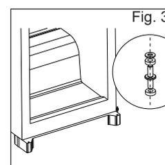
5 - Mettere l'apparecchio nuovamente in posizione verticale e sistemare ora la porta del frigorifero sul perno di arresto inferiore.
