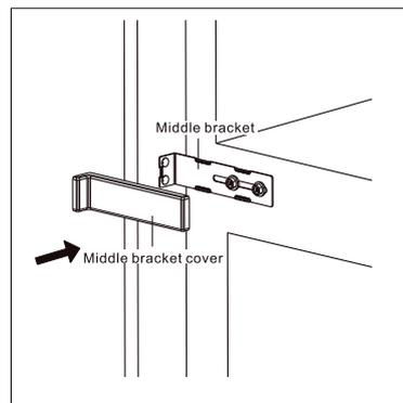
8) In ultimo fissare con viti la staffa intermedia laterale del frigorifero al lato del mobile di incasso. Quindi ricoprire la staffa con il COPRI-STAFFA in dotazione.
