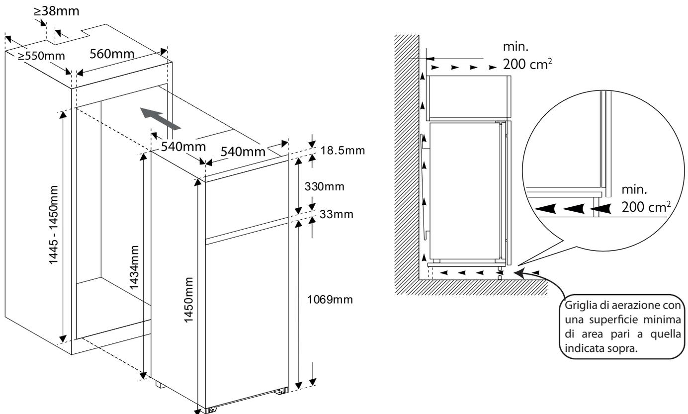
1) Inserire delicatamente il frigorifero nel vano per l'incasso. Accostarlo in modo il più possibile aderente al lato in cui si trovano le cerniere delle porte, e verificate che le porte del frigorifero e del mobile siano accostabili perfettamente.
