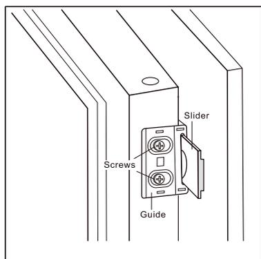
2) Fissate con le viti, sul bordo di ogni porta, 2 GUIDE in alto e in basso, utilizzando i fori per le viti già presenti sul bordo. Quindi inserire le SLITTE nelle guide in modo che sporgano leggermente con l'ultimo foro, e verificate che aderiscano alle porte del mobile. Chiudere le porte del frigorifero e del mobile assicurandosi che possano farlo senza interferenze (altrimenti sistemate meglio la posizione del frigorifero).
