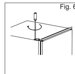
9 - Controllare il corretto allineamento delle porte alle guarnizioni e successivamente serrare completamente tutte le viti, reinserire le coperture precedentemente rimosse.
