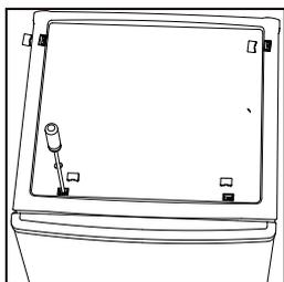
2-Rimuovere la cerniera sul lato superiore del frigorifero, svitando le viti che la fissano al prodotto; rimuovere la porta del vano superiore sfilandola dall'alto. Riporre la porta su una superficie morbida onde evitare danni.
