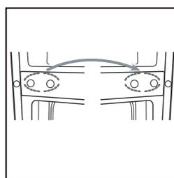
6-Dopo aver inclinato leggermente l'apparecchio, rimuovere la cerniera sulla parte inferiore dell'apparecchio ed entrambi i piedini.
