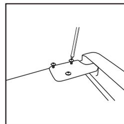
3-Rimuovere la cerniera intermedia fra le due porte, come mostrato in figura; rimuovere la porta del vano inferiore sfilandola dall'alto. Riporre la porta su una superficie morbida onde evitare danni.
