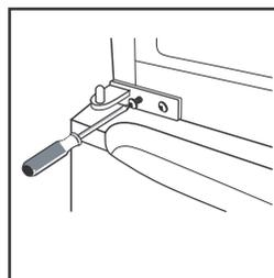
10-Ruotare la cerniera sul lato superiore di 180° rispetto alla posizione in cui era precedentemente fissata e spostare il perno sul lato opposto (come mostrato in figura a fianco).
