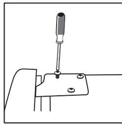
12-Reinserire il top di copertura e fissarlo con le viti precedentemente smontate.
