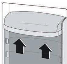
I balconi della porta possono essere posizionati a diverse altezze in funzione delle esigenze specifiche. Per spostare un balcone sollevarlo nella direzione delle frecce e inserirlo appoggiandolo su supporti differenti ad una diversa altezza.
