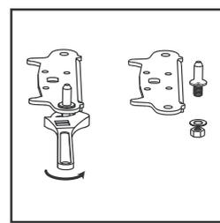
8-Applicare la cerniera sul lato opposto e riavvitarla con le sue viti. Riposizionare entrambi i piedini regolabili. Inserire la porta del vano inferiore sulla staffa della cerniera inferiore avendo cura che le guarnizioni siano allineate.
