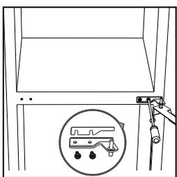
4-Spostare i tappi di copertura per i fori di fissaggio delle cerniere, sul lato opposto a quello dove si trovano.
